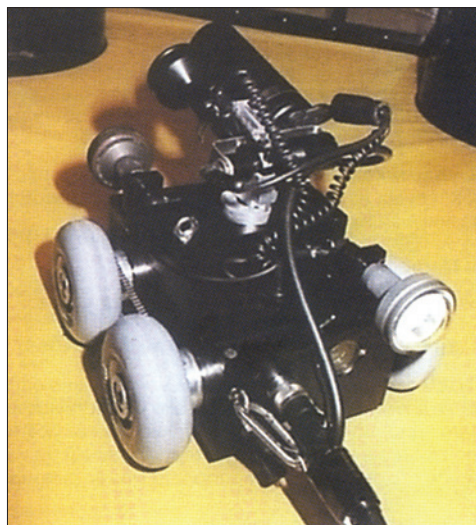
Радиационно стойкие телевизионные камеры, смонтированные на дистанционно управляемых транспортных средствах
