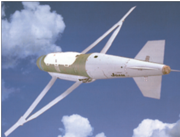
Управляемая авиационная бомба с модулем «Даймонд Бэк», разработанная по программе JDAM-ER
