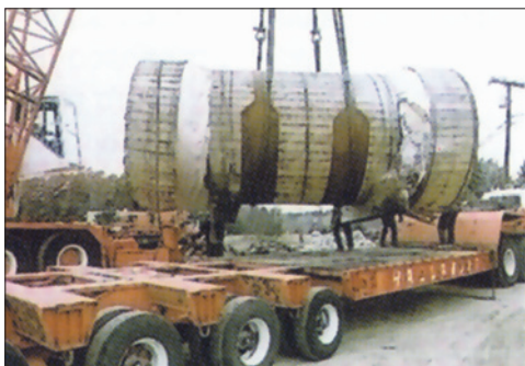
Рабочая камера изостатического прессы в деревянной транспортной упаковке
